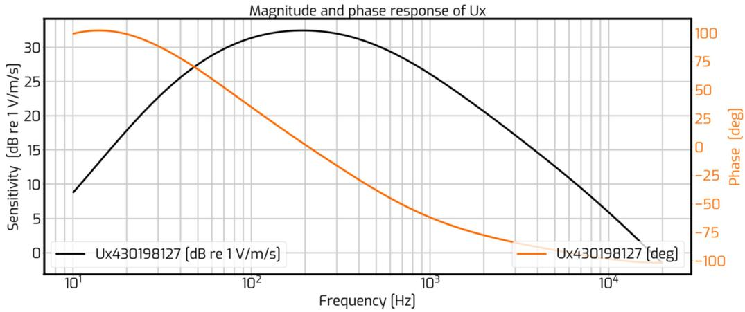
**TYPICAL FREQUENCY RESPONSE – SOUND PRESSURE MICROPHONE:**
