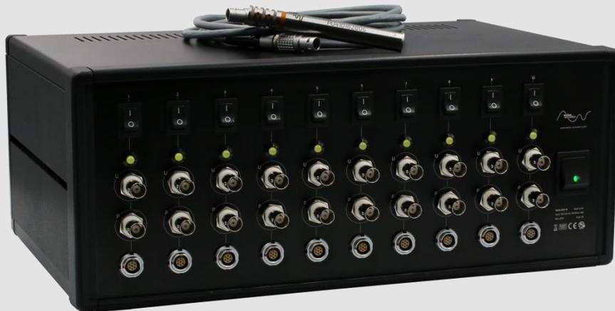
Die Weles BOX X von Weles Acoustics ist ein modulares Gerät, das für die Unterstützung von bis zu zehn Standard-WA101 1/2" PU-Schallsonden ausgelegt ist. Jede Sonde kann separat über eine spezielle Weles BOX-Karte betrieben werden, die mit einem eigenen Netzschalter, einem Sondereingangsanschluss und 2 analogen BNC-Ausgangskanälen ausgestattet ist - ein erster Kanal für den Schalldruck, der zweite für die Schallschnelle.
